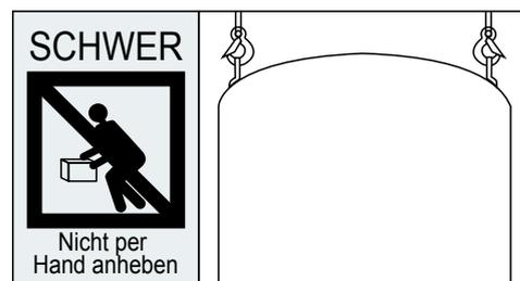
Versuchen Sie niemals, zum Bewegen des Verdichters Kraft auf den Anschlusskasten auszuüben. Ansonsten können sowohl der Anschlusskasten als auch die Komponenten darin stark beschädigt werden.
