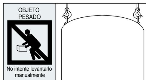
No levante jamás el compresor sujetándolo por una sola anilla de izado. El compresor es demasiado pesado como para levantarlo por una sola anilla de izado; existe el riesgo de que la anilla pueda soltarse del compresor, lo que podría producir tanto daños materiales cuantiosos como lesiones.
