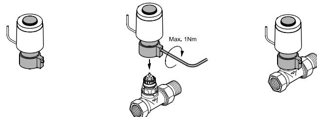
**Рис. 7.** Смонтируйте электроприводы на клапанный вставки и зафиксируйте их с помощью 2 мм шестигранного ключа.. Подключите приводы к коммутационной панели.
