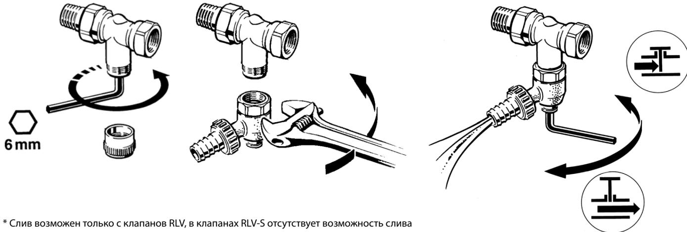
\* Слив возможен только с клапанов RLV, в клапанах RLV-S отсутствует возможность слива
