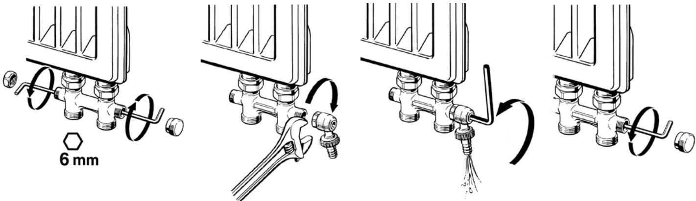
\* Слив возможен только с клапанов RLV-KD, в клапанах RLV-KS отсутствует возможность слива
