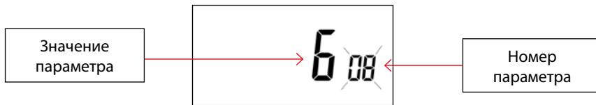
Нажимая кнопки + и – , находим параметр 90. Нажимая клавиши ▲ или ▼, устанавливаем режим работы датчика температуры:
