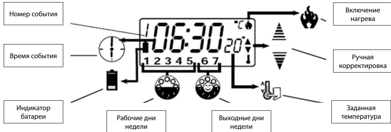
1) Перед началом работы тонким неметаллическим предметом нажмите кнопку **RESET** до момента как дисплей погаснет. Это обеспечит корректную работу микропроцессора в терmostате.
