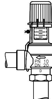
Клапан AVDO настраивается на сопротивление системы отопления. В случае если сопротивление системы не известно желательно установить настройку на клапане в пределах 20 кПа (0,2 бар), в случае если при такой настройке не обеспечивается прогрев
