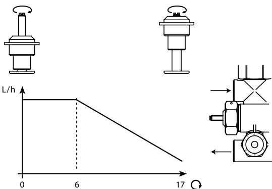
Для настройки расхода в узле FHM-Cx могут применяться регулятор расхода FH-FL и измерительная диафрагма FM-MS.
