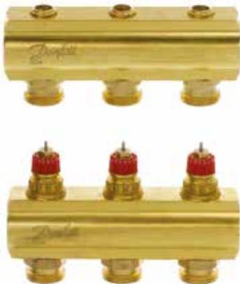
Распределитель состоит из подающего и обратного коллекторов. Подающий коллектор имеет возможность отключения каждого из контуров системы и может быть укомплектован ротаметрами (серия FHF-F). Обратный коллектор оборудованстроенными клапанами с предварительной настройкой пропускной способности, что позволяет обеспечить оптимальную гидравлическую балансировку системы.
