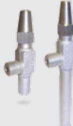
Las válvulas de aguja de acero inoxidable SNV-SS presentan un diseño compacto y apenas requieren mantenimiento. Son idóneas para aplicaciones industriales exigentes debido a su diseño robusto y al elevado nivel de seguridad operativa que ofrecen. Su diseño da lugar a unas condiciones de flujo elevado. Las válvulas SNV-SS presentan una presión máxima de funcionamiento de 52 bar y su uso es posible a temperaturas comprendidas entre -60 °C y +150 °C.
