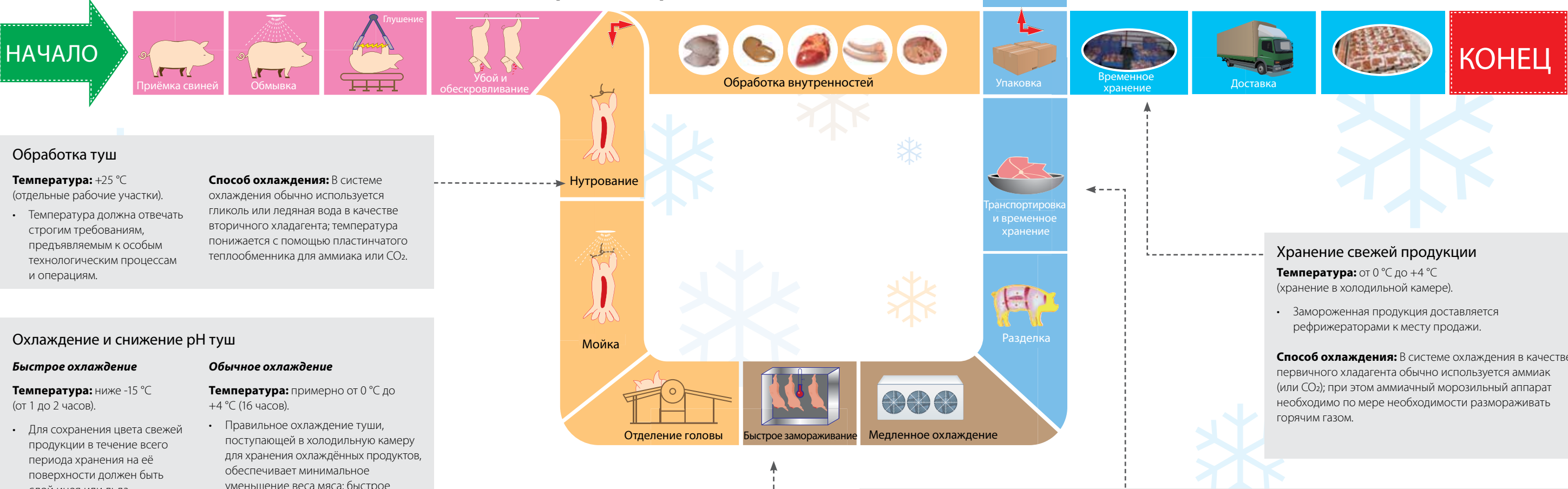
Схема последовательности технологических операций по обработке свиней
