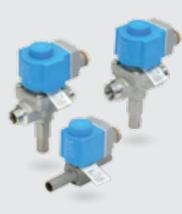
EVRS和EVRST不锈钢电磁阀有三种类型：直动式、伺服式和动力伺服式。专门为零压降条件下还能保持打开而设计的动力伺服电磁阀，可以用在液体、吸气和回气管路中。EVRS和EVRST不锈钢电磁阀配备一个手动开启的阀轴，工作压力在50 bar，可处理的媒介温度为-40°C到+105°C（最大温度取决于线圈）。
