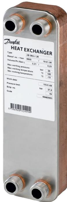
L'échangeur en acier inoxydable de petite taille à plaques brasées au cuivre **XB06** à une passe est conçu pour les systèmes de chauffage centralisé avec différentes températures du réseau, une pression différentielle élevée et variable et requérant une température hors soutirage élevée.
