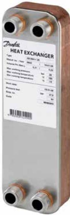
Mali **XB06** bakarom lemljeni razmenjivač od nerđajućeg čelika sa jednim prolazom dizajniran je za sisteme daljinskog grejanja sa promenljivim napojnim temperaturama, visokim i promenljivim diferencijalnim pritiskom i tamo gde je potrebna visoka temperatura u stanju mirovanja.
