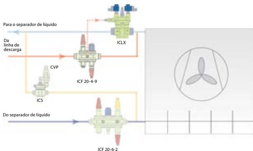
As válvulas ICLX são usadas nas linhas de sucção úmida e de sucção seca para abertura diante de uma alta pressão diferencial, por exemplo, após o degelo a gás quente em sistemas de refrigeração industrial de grande porte com amônia ou refrigerantes fluorados.
