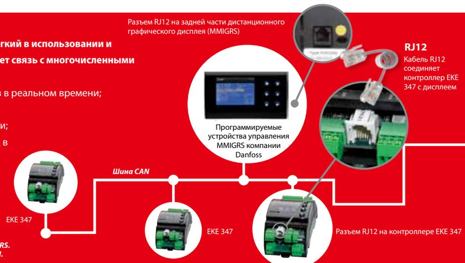
Все подключенные устройства управления Danfoss MMIGRS. Регулятор уровня EKE 347, подключенный через шину CAN.
