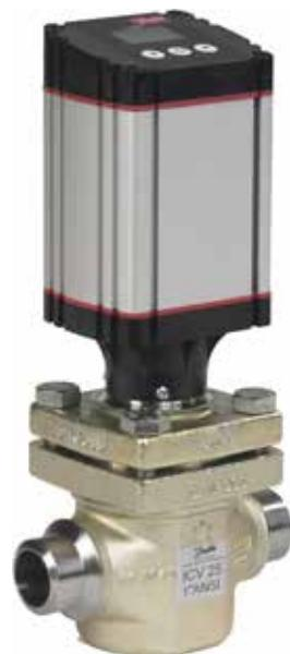
Кодирующие устройства обеспечивают выдачу данных в реальном времени о положении клапана. Он генерирует аварийный сигнал в случае закупоривания клапана. Если выявляется потеря шага, крутящий момент автоматически увеличивается. Интеллектуальная компенсация силы (IIFC) гарантирует компенсацию больший колебаний давления.
