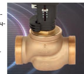
Когда включается источник питания, электропривод автоматически подстраивается под конечные положения штока клапана. Направление перемещения и позиция штока четко отображаются на индикаторе, которым снабжен электропривод.
