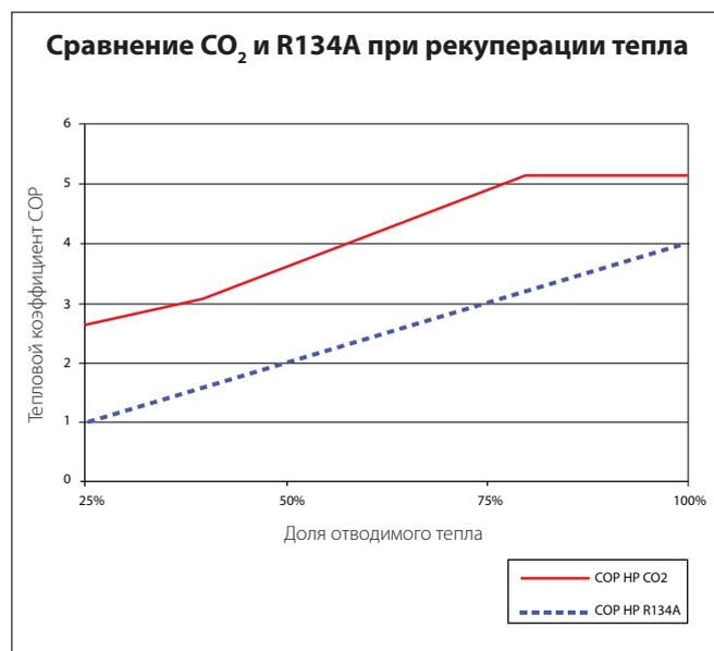
Из этого графика видно, что тепловой коэффициент для CO<sub>2</sub> лучше, чем для R134A, на величину от 25 до 150%. Самое лучшее значение получается при неполной нагрузке, которая имеет место на протяжении большей части года.
