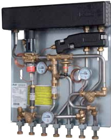
Danfoss Wohnungsstationen der Serie Termix VMTD-F sind komplette hydraulische Schnittstellen mit einem kompakten, hoch leistungsfähigen Plattenwärmeübertrager, der bei Zapfung sofort Warmwasser zur Verfügung stellt. Zusätzlich kann die Station mit Anschlüssen für die Wohnraumheizung geliefert werden, einschließlich Armaturen zur Steuerung der Beheizung von Radiatoren oder Fußbodensystemen.
