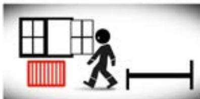
L'aria fredda o fresca entra ed è rilevata dal termostato living connect ®; poco dopo il radiatore capisce che la finestra è aperta e il termostato spegne il riscaldamento.
