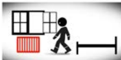
Čerstvý, chladný vzduch proudí dovnitř a je detekován termostatickou hlavicí living connect® ; krátce poté si radiátor bude jistý, že je otevřené okno , a termostatická hlavice vypne vytápění.
