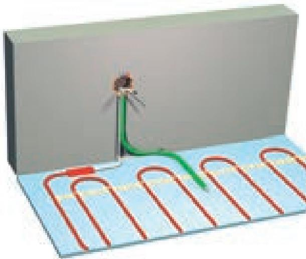
В процессе заливки стяжки и укладки покрытия пола следует обращать внимание на целостность трубы термодатчика (отсутствие вмятин и повреждений).
