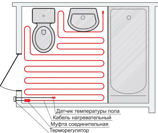
1. Определить место установки терморегулятора (при необходимости сделать штробу в стене для скрытой проводки). Выделить свободную площадь. Нарисовать схему раскладки нагревательного кабеля. При необходимости предусмотреть теплоизоляцию и промежуточный материал (например, армирующая сетка и/или предварительная стяжка).
