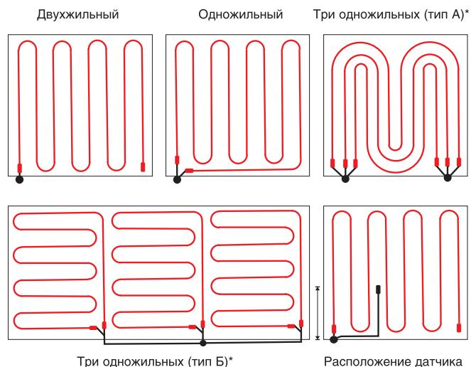
Тип А и Б — трехфазная система с подключением по схеме типа звезда/треугольник. При распределении мощности на три фазы систему подключают к терморегулятору через контактор.
