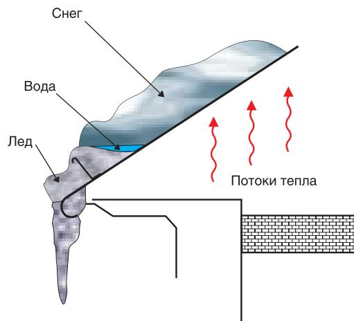
Тепло, поступая через верхнее перекрытие и чердачное пространство, достигает кровли. Таким образом, происходит нагрев кровли, что при небольших отрицательных температурах наружного воздуха может привести к положительной температуре на поверхности самой кровли. В результате происходит таяние снега на кровле и образуется сток талой воды в водосток, который в свою очередь лишен «паразитного» подогрева. В холодном водостоке вода замерзает, образуя сосульки и наледь.
