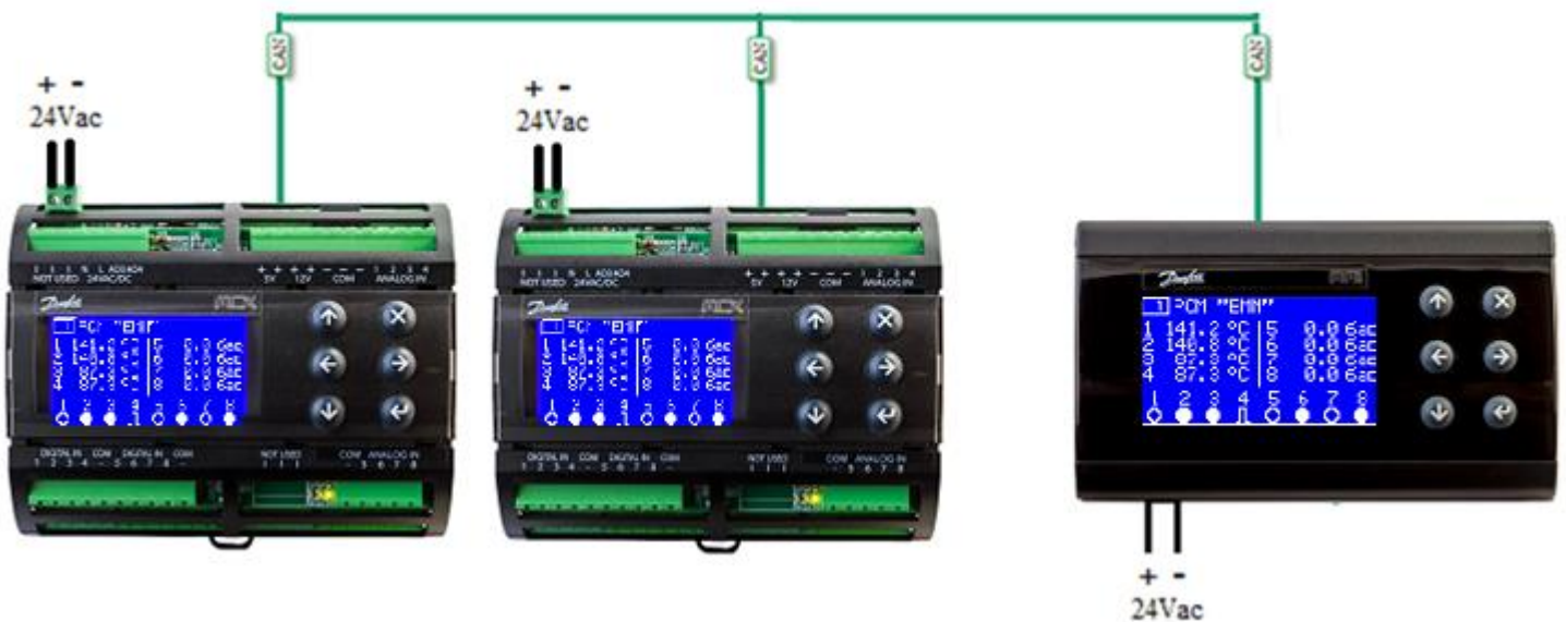
Рисунок 9. Подключение внешнего дисплея к двум модулям. В CAN- подключении среднего контроллера отсутствует перемычка между R120-CANH.
