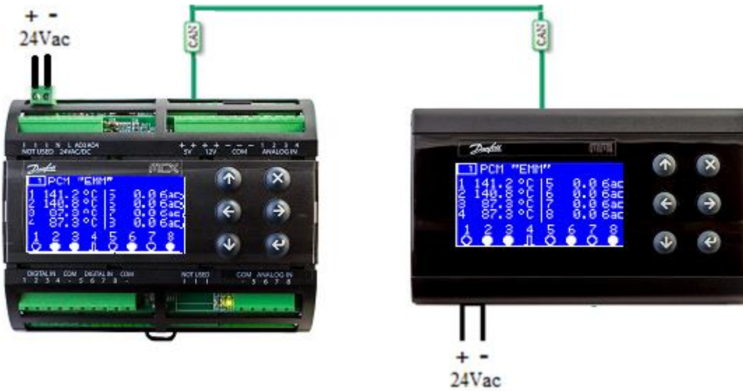
Рисунок 8. Подключение внешнего дисплея к одному модулю
