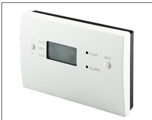
O regulador é utilizado para o controle de temperatura da água de aquecimento num sistema de painéis solares. A bomba de circulação do circuito de aquecimento solar é controlada com base no diferencial de temperatura entre o painel solar e o reservatório de água quente.
