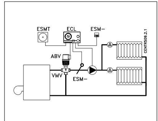
Le moteur thermohydraulique ABV est muni d'un système à soufflet sûr qui est activé par un élément thermique.
