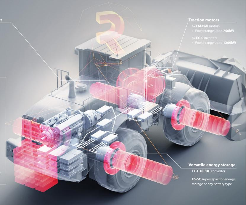
**EDITRON OFF-HIGHWAY SYSTEM** - SERIAL HYBRID
