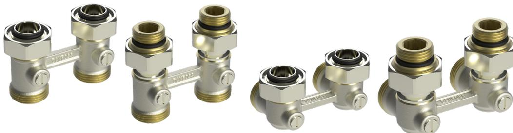
La vanne avec pièce en H type RLV-KB permet d'isoler individuellement tout radiateur à entraxe de 50 mm, ce qui permet, par exemple, de réaliser facilement des réparations sans que les autres éléments du système soient affectés.
