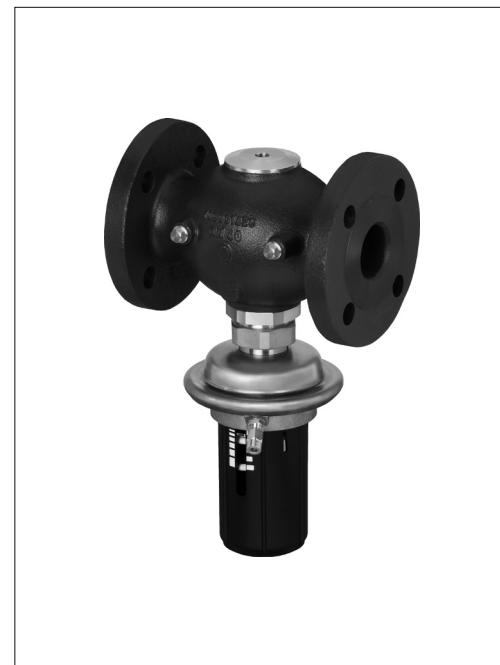
AVP(-F) Le régulateur de pression différentielle auto-moteur est principalement utilisé dans les systèmes de chauffage urbain. Le régulateur se ferme lorsque la pression différentielle augmente.
