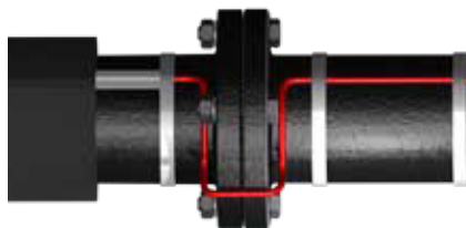
Eksempel på kabelmontage på en flange.
