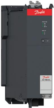
Il modulo PSM 510 genera una tensione sul circuito intermedio di 565–680 V ed è disponibile in tre taglie di potenza da 10, 20 o 30 kW e capacità di sovraccarico del 200%. Per ottenere un'uscita nominale fino a 60 kW, installare due unità PSM 510 in parallelo.
