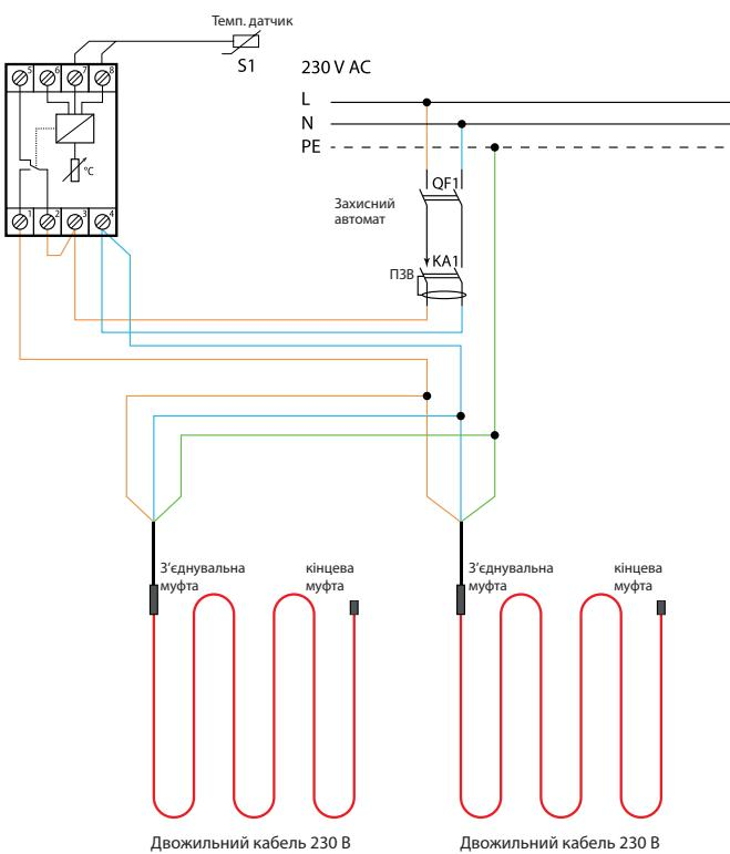
**Підключення терморегуляторів двожильних нагрівальних кабелів (400 В) через контактор.**
