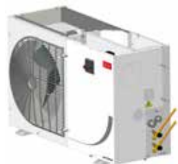
Pasul 3: Scoateți toate șuruburile panoului lateral.
