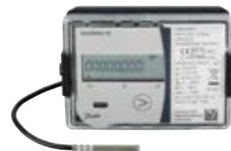
MID konformitätsbewertet, max. Mediumstemperatur 130°C, Einbau im Rücklauf, PN25, inkl. Mbus, Energieeinheit MWh, beide Temperaturfühler als Tauchfühler ausgeführt
