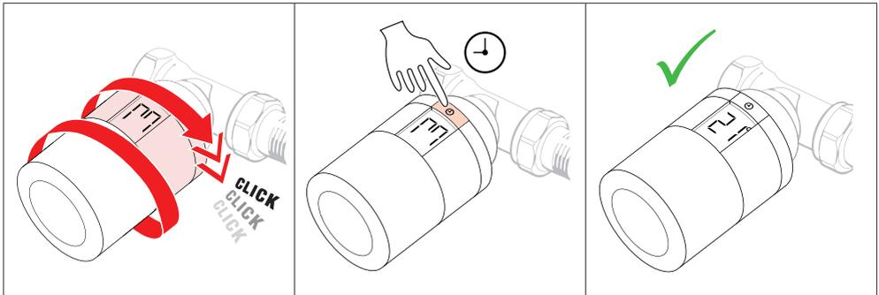
Verschrauben Sie den Danfoss Eco™ mit dem montierten Adapter, bis Sie ein Klicken hören. Nachdem Sie den Thermostaten ordnungsgemäß befestigt haben, drehen Sie das Display in die gewünschte Ausrichtung.
