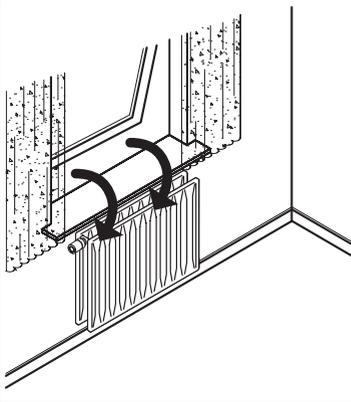
Danfoss Eco™ verfügt über eine Fensteröffnungserkennung, durch die das Ventil geschlossen wird, wenn die Raumtemperatur rapide sinkt. So werden Wärmeverluste verringert. Die Wärmezufuhr wird für 30 Minuten abgestellt, bevor der Danfoss Eco™ in seine ursprüngliche Einstellung zurückkehrt. Wenn die Fensteröffnungserkennung aktiviert wurde, ist diese Funktion 45 Minuten lang gesperrt.
