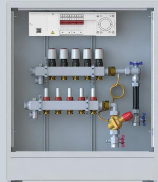
24 V OTA Icon™ Hauptregler für Icon™ 24 V verdrahtete oder drahtlose Raumthermostate; senkrechte Anschlüsse inkl. AB-PM Set (Differenzdruckregler, Durchflussbegrenzer, Wärmemengenzähler-Passtück), wahlweise rechts oder links montiert
