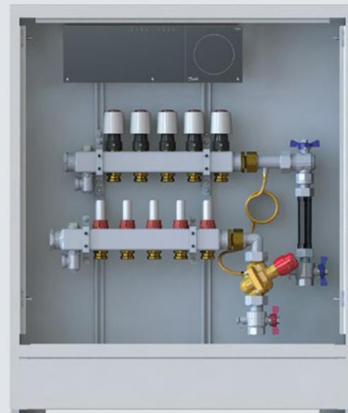
230 V Icon™ Hauptregler für Icon™ 230 V verdrahtete Raumthermostate; senkrechte Anschlüsse inkl. AB-PM Set (Differenzdruckregler, Durchflussbegrenzer, Wärmemengenzähler-Passtück), wahlweise rechts oder links montiert
