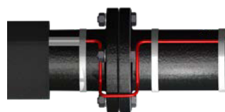
Fűtőkábel átvezetése csőkarimán.
