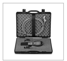
PFM 100 用于测量水系统内阀门两侧的压差。
