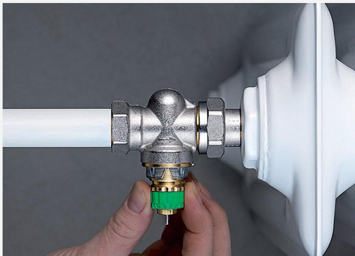
■ Le robinet thermostatique *Dynamic Valve*™ RA-DV est auto-équilibrant car il possède un régulateur de  $\Delta p$  intégré.
