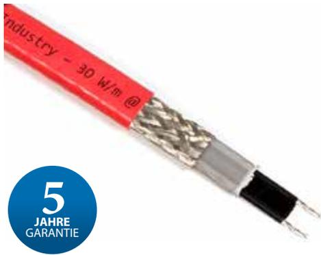
Ein temperaturabhängiges Widerstandselement zwischen zwei parallel geführten Kupferleitern reguliert und begrenzt die Wärmeabgabe des Heizbandes. Dieses Einstellen der Leistung vollzieht sich an jeder Stelle des Heizbandes, entsprechend der dort herrschenden Umgebungstemperatur.
