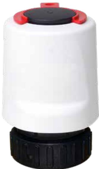
Der thermische Stellantrieb DEVlact™ ist mit einer sichtbaren Positionsanzeige ausgestattet, an der zu erkennen ist, ob das Ventil geöffnet oder geschlossen ist. DEVlact™ ist für die Versorgungsspannung 230 Volt in den Versionen stromlos geschlossen (NC) und stromlos geöffnet (NO) verfügbar.
