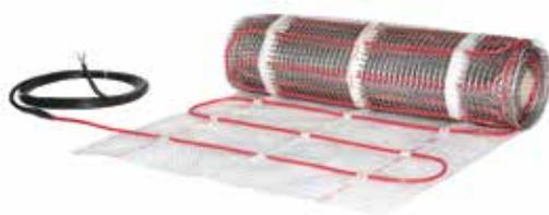
Die ECflex ist eine extrem hochqualitative Fertigheizmatte. Die Zweileiterheizleitung verfügt über eine 360°-Abschirmung und einem festen Außenmantel (nicht UV-beständig), welche auf der Kunststoffmasche befestigt ist. Der runde Heizleiter und die robuste Konstruktionsweise ermöglichen eine schnelle, unkomplizierte und sichere Installation in mehreren Innenbodenkonstruktionen.
