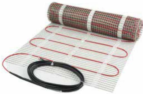
DEVI<sup>™</sup> ist eine extrem hochqualitative Heizmatte. Die Zweileiterheizleitung verfügt über eine 360°-Abschirmung und eine robuste rote PVDF-Außenisolierung. Die robuste Konstruktionsweise und die geringe Aufbauhöhe von 3,5 mm ermöglichen eine schnelle, unkomplizierte und sichere Installation, speziell auch bei der Renovierung bestehender Fußböden.
