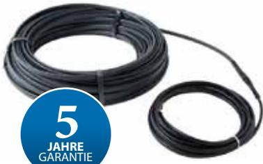
DEVlceguard™ ist ein selbstlimitierendes Heizband, das zur Eis- und Schneefreihaltung von Dächern, Ablaufrinnen und Fallrohren eingesetzt wird. DEVlceguard™-Heizband sollte nicht in direktem Kontakt mit Bitumen stehen. Durch die Selbstlimitierung des Heizbandes variiert die Leistung punktuell je nach Umgebungstemperatur. Das Heizband ist flexibel und einfach zu installieren. Der Einbau eines Thermostates wird empfohlen.
