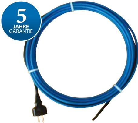
DEVipeheat™ 10 (DPH) ist ein steckfertig konfektioniertes, selbstlimitierendes Parallelheizband, dessen temperaturabhängiges Widerstandselement die Heizleistung reguliert und begrenzt. Dieser Prozess vollzieht sich – abhängig von der Umgebungstemperatur – an jeder Stelle des Heizbandes. Die Verlegung erfolgt auf der Oberfläche des zu schützenden Rohres.
