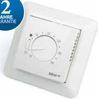
DEVlreg™ 530 ist ein elektronischer Thermostat, der einen Bodenfühler verwendet, um die gewünschte Bodentemperatur zu messen und zu regeln. Er ist für Unterputzmontage in einer Schalterdose geeignet.
