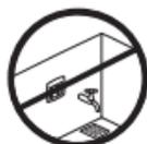
Il ne faut pas installer le thermostat dans une pièce humide. Placez-le dans une pièce adjacente. Placez-le toujours conformément aux réglementations locales relatives aux classes IP.
