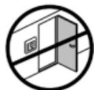
Installez toujours le thermostat à au moins 50 cm des fenêtres et des portes.
