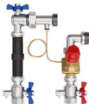
Le kit de raccordement AB-PM est une configuration compacte et rapide, conçue pour créer un équilibre hydraulique optimal dans les boucles horizontales, pour les applications de chauffage par radiateur et par le sol. La limitation du débit indépendamment de la pression différentielle est désormais garantie.
