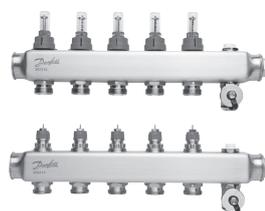
Le collecteur SSM est utilisé pour réguler le débit d'eau dans les systèmes de chauffage par le sol. Chaque tube du système de chauffage par le sol est raccordé au collecteur, ce qui permet de réguler le débit d'eau ou l'apport thermique dans chaque pièce du bâtiment de manière individuelle.
