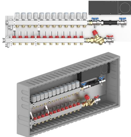
Die **Danfoss UnoFloor EasyFit** ist eine vormontierte druckunabhängige Abgleichs- und Regelungseinheit für Fussbodenheizungen. Die Regelungseinheit UnoFloor EasyFit wird verdrahtet und vormontiert ausgeliefert und ist für den Einbau in einen Sockelkasten oder für eine Aufputz-Decken- bzw. Aufputz-Wandmontage vorgesehen.
