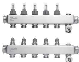
Der SSM-Verteiler wird zur Durchflussregelung in Fußbodenheizungen eingesetzt. Die einzelnen Heizkreise des Fussbodenheizungssystems werden an den Verteiler angeschlossen. Dadurch können Durchfluss und Wärmeabgabe für einzelne Räume eines Gebäudes individuell geregelt werden.
