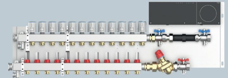
Optimisé pour l'utilisation dans un caisson de socle (à fournir par le client), y compris régulateur principal 230 V Icon™ pour thermostats d'ambiance câblés Icon™ 230 V ; raccords horizontaux y compris kit AB-PM (régulateur de pression différentielle, limiteur de débit, calorimètre), montage à droite ou à gauche au choix
