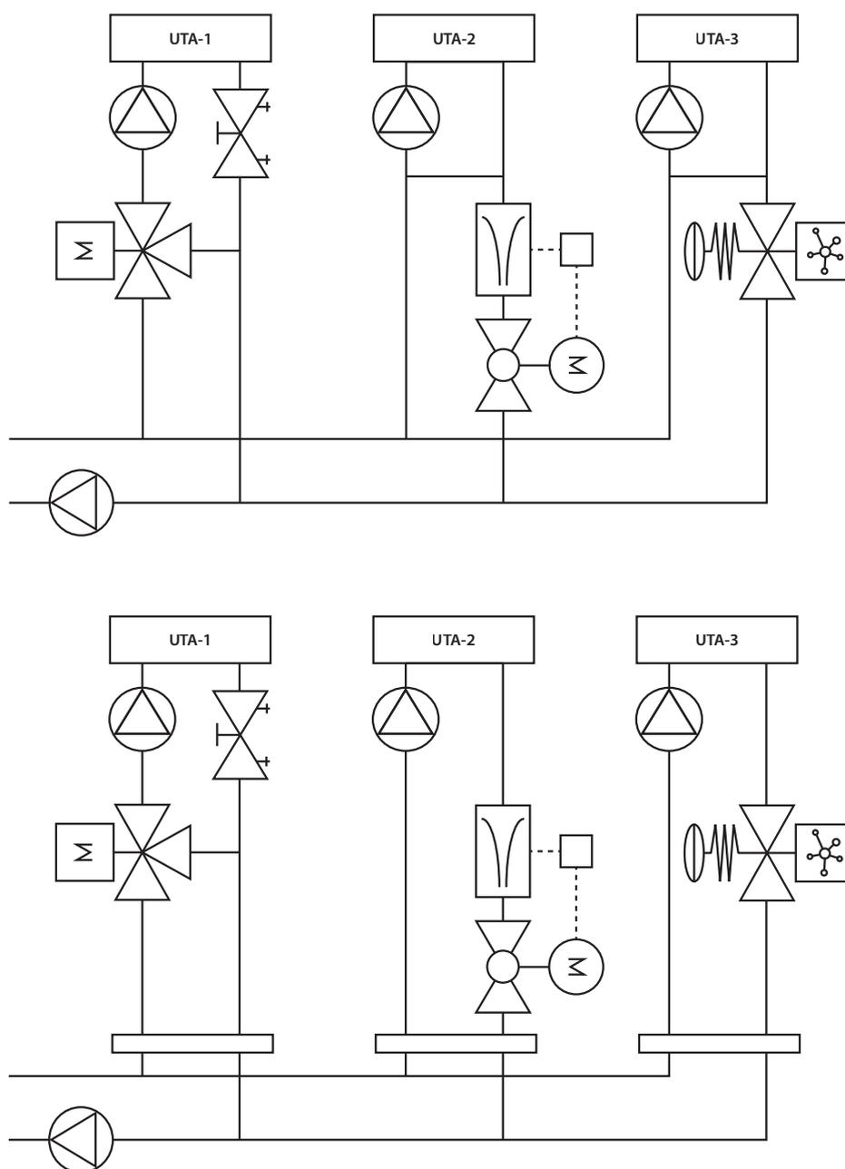
Sin embargo, las soluciones de válvula de 2 vías (EPIV y PICV) están expuestas a la altura manométrica de la bomba principal, ya que se utiliza para inyectar el agua en el circuito de la UTA en circulación constante. Por lo tanto, la caída de presión sobre las válvulas cambia porque esa parte del sistema funciona como un sistema de caudal variable estándar. Cuando la válvula se cierra, la presión diferencial sobre ella aumenta y fluctúa cuando otras válvulas del sistema abren o cierran.
