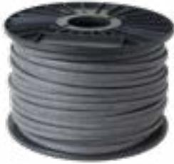
DEVlceguard™ ist ein selbstlimitierendes Heizband, das zur Eis- und Schneefreihaltung von Dächern, Ablaufrinnen und Fallrohren eingesetzt wird. DEVlceguard™-Heizkabel sollten nicht in direktem Kontakt mit Bitumen stehen. Durch die Selbstlimitierung des Heizbandes variiert die Leistung punktuell je nach Umgebungstemperatur. Das Heizband ist flexibel und einfach zu installieren. Der Einbau eines Thermostates wird empfohlen.
