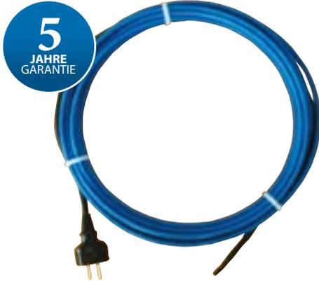
DEVipeheat™ 10 (DPH) ist ein steckfertig konfektioniertes, selbstlimitierendes Parallelheizband, dessen temperaturabhängiges Widerstandselement die Heizleistung reguliert und begrenzt. Dieser Prozess vollzieht sich – abhängig von der Umgebungstemperatur – an jeder Stelle des Heizbandes. Die Verlegung erfolgt auf der Oberfläche des zu schützenden Rohres.
