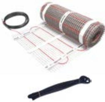
Devicomfort™ Dünnbett-Heizmatten mit einem Kaltleiter sind ein Direktheizsystem zur Einbettung in Ausgleichsmasse oder Flexkleber unterhalb des Fußbodenbelages. Die auf einem selbstklebenden Glasfasergewebe fixierte Teflon-Spezialheizleitung (Typ DTIR mit Abschirmung) hat einen Durchmesser von 4 mm.
