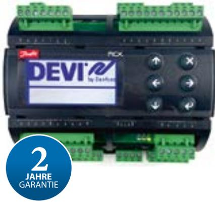
DEVIreg™ Hotwater ist ein elektronischer, programmierbarer Regler mit 4 Kanälen für die Montage auf DIN Schienen. Jeder Kanal kann individuell eingestellt werden, um heißes Wasser manuell oder nach einem Zeitplan zu desinfizieren. Die Sensoren der Kanäle können aus 7 verschiedenen Temperatursensoren ausgewählt werden einschließlich NTC 15 kOhm bei 25°C.
