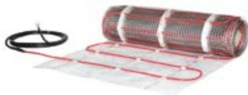
Die ECflex ist eine extrem hochqualitative Fertigheizmatte. Die Zweileiterheizleitung verfügt über eine 360°-Abschirmung und einem festen Außenmantel (nicht UV-beständig), welche auf dem Trägernetz befestigt ist. Der runde Heizleiter und die robuste Konstruktionsweise ermöglichen eine schnelle, unkomplizierte und sichere Installation in mehreren Innenbodenkonstruktionen.
