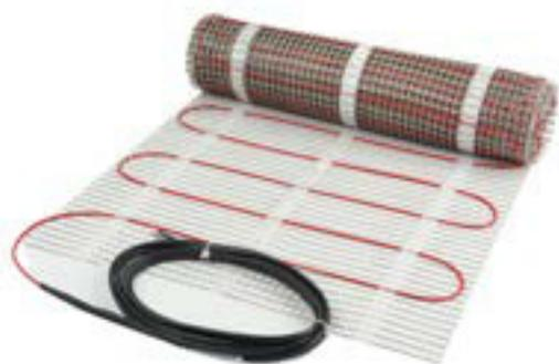
DEVImat™ ist eine extrem hochqualitative Heizmatte. Die Zweileiterheizleitung verfügt über eine 360°-Abschirmung und eine robuste rote PVDF-Außenisolierung. Die robuste Konstruktionsweise und die geringe Aufbauhöhe von 3,5 mm ermöglichen eine schnelle, unkomplizierte und sichere Installation, speziell auch bei der Renovierung bestehender Fußböden.
