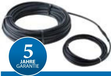
DEVlceguard™ ist ein selbstlimitierendes Heizband, das zur Eis- und Schneefreihaltung von Dächern, Ablaufrinnen und Fallrohren eingesetzt wird. DEVlceguard™-Heizkabel sollten nicht in direktem Kontakt mit Bitumen stehen. Durch die Selbstlimitierung des Heizbandes variiert die Leistung punktuell je nach Umgebungstemperatur.
