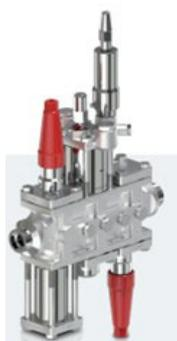
Le module ICFG peut accueillir tous les inserts ICS 25 et être configuré avec des systèmes pilotes exactement identiques à ceux de l'ICS. Ces nouvelles configurations vous permettront de couvrir un plus grand nombre d'applications avec l'ICF, telles que le régulateur de pression de l'évaporateur pour les systèmes plus petits ainsi que les régulateurs de sortie pour l'alimentation en gaz chaud.
