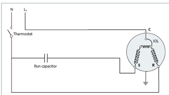
**El cableado PSC** con un condensador de funcionamiento solo es la solución de cableado predeterminada para los compresores MLZ monofásicos.
