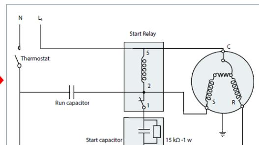
**El cableado CSR** proporciona un par motor adicional en el arranque, utilizando un condensador de arranque en combinación con el condensador de funcionamiento. El condensador de arranque solo se conecta durante la operación de arranque. Se utiliza un relé de potencia para desconectarlo después de la secuencia de arranque.
