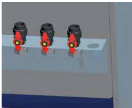
Montaža krogelnih pip.
