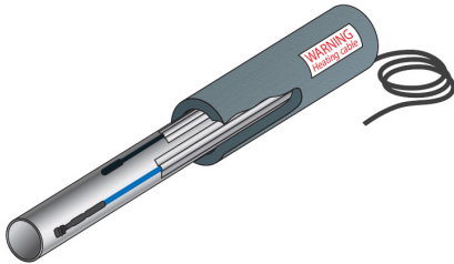
Asennettuna vesiputken ulkopuolelle
