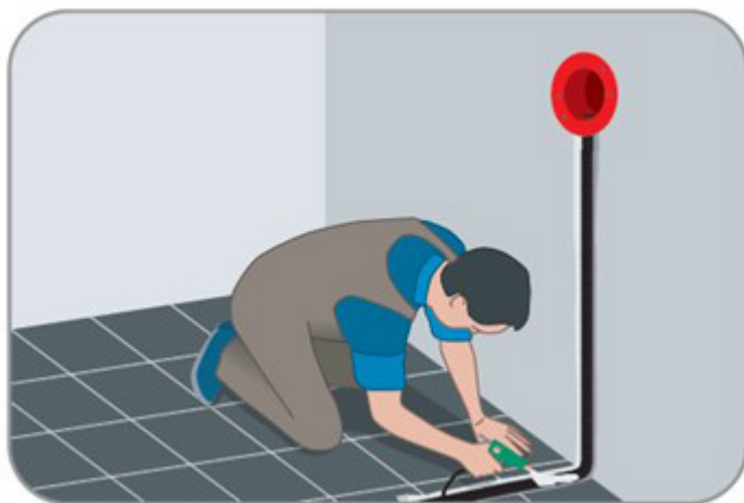
Foto 7 – Versamento del calcestruzzo, colla per piastrelle o materiali simili nel pavimento
