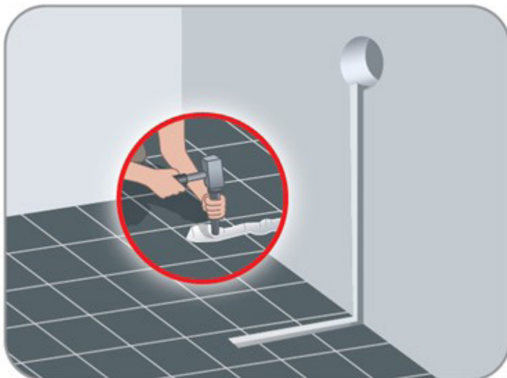
Slika 1 – kanal u podu i zidu s otvorom za električnu kutiju
