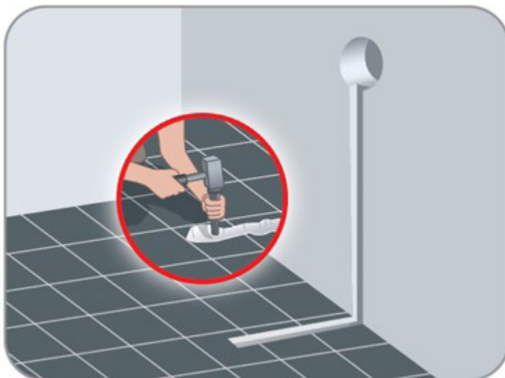
Photo 1 – Rainure dans le sol et le mur avec trou pour le boîtier de raccordement
