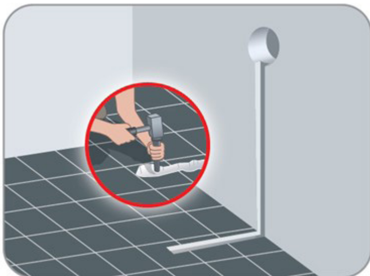
1 nuotrauka – kanalas grindyse ir sienoje su skyle elektros paskirstymo dėžute
