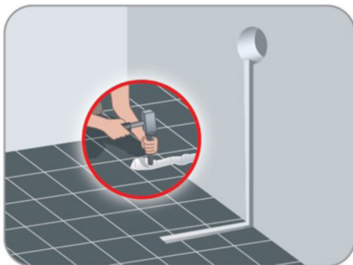
Billede 1 – Kanal i gulv og væg med hul til elboks
