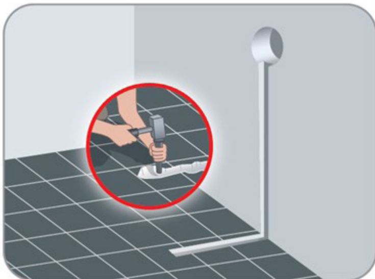
Foto 1 – canale nel pavimento e nella parete con il foro per la scatola elettrica
