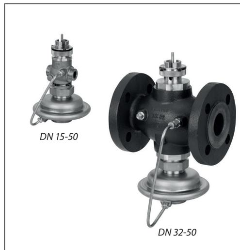
L'AVQM est un régulateur de débit automoteur équipé d'une vanne de réglage intégrée, développé pour être utilisé dans les systèmes de chauffage urbain/de refroidissement. Le régulateur permet d'éviter de dépasser le débit maximum défini. En combinaison avec des actionneurs électriques AMV(E) et les régulateurs électroniques ECL, le débit et la température peuvent être régulés pour réaliser des économies d'énergie encore plus importantes.
