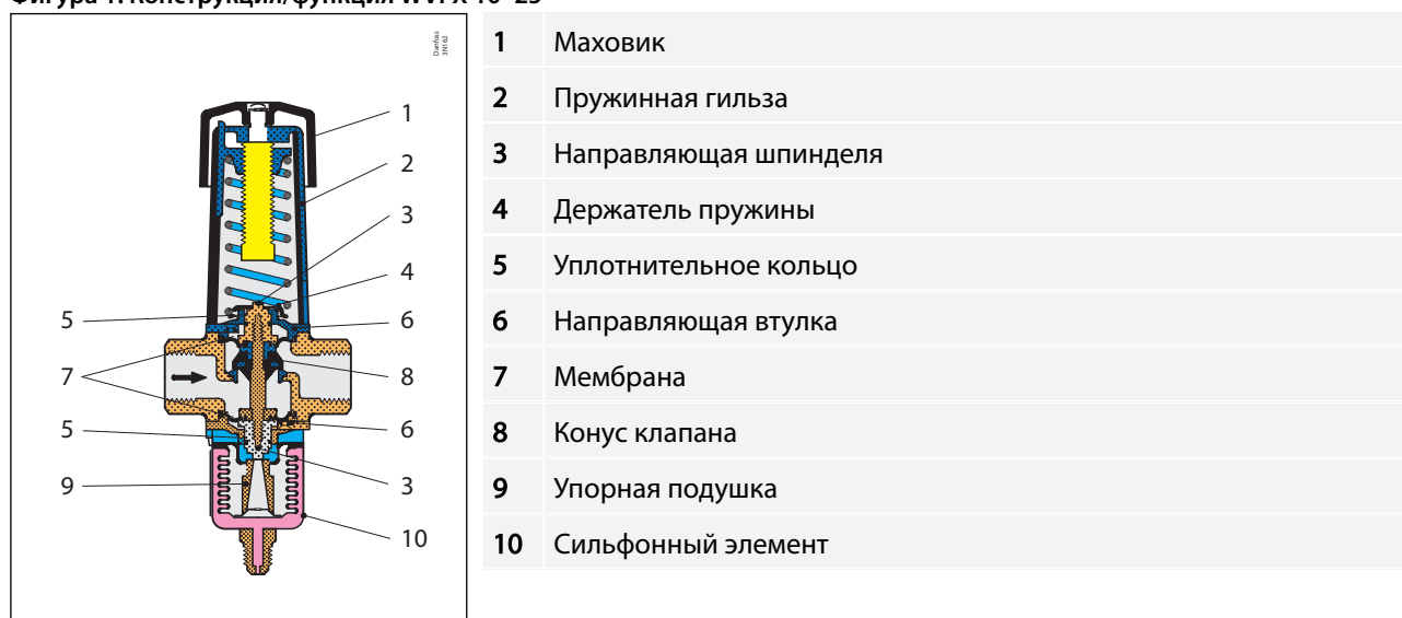
Фигура 1: Конструкция/функция WVFX 10–25
