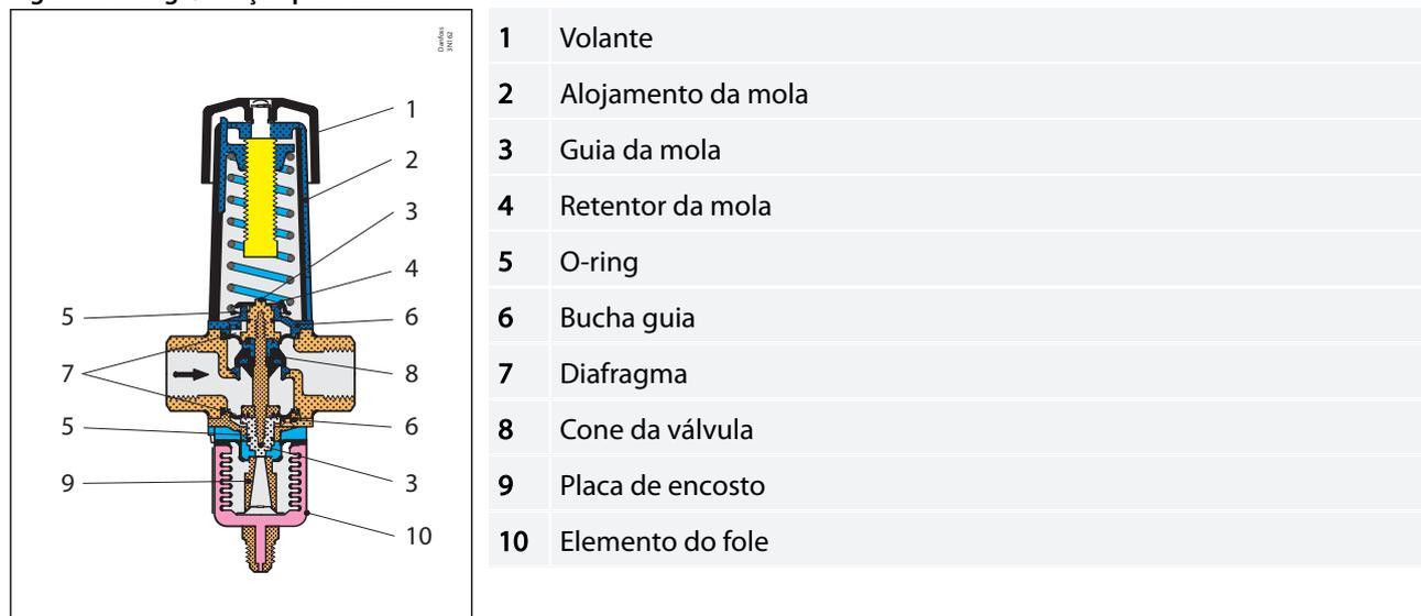
O cone da válvula (8) é feito em placa de latão com uma camada vulcanizada de borracha artificial que forma uma vedação elástica contra o assento da válvula. A válvula é vedada externamente pelos diafragmas (7).
