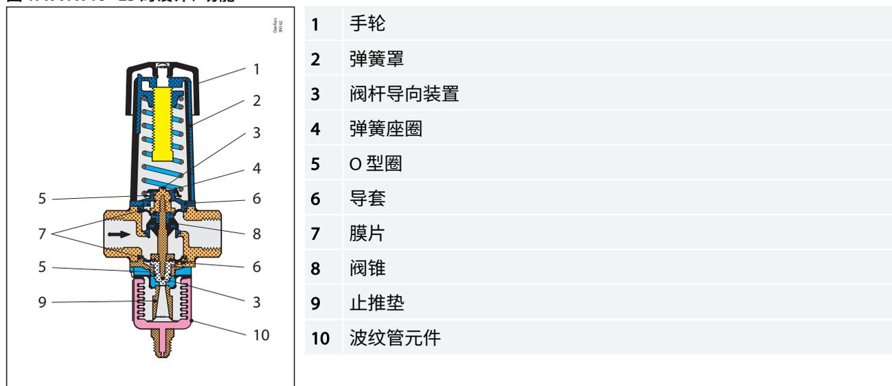
阀锥 (8) 为黄铜板片，采用人造硫化橡胶层形成了对阀座的弹性密封。阀门由膜片从外部密封 (7)。
