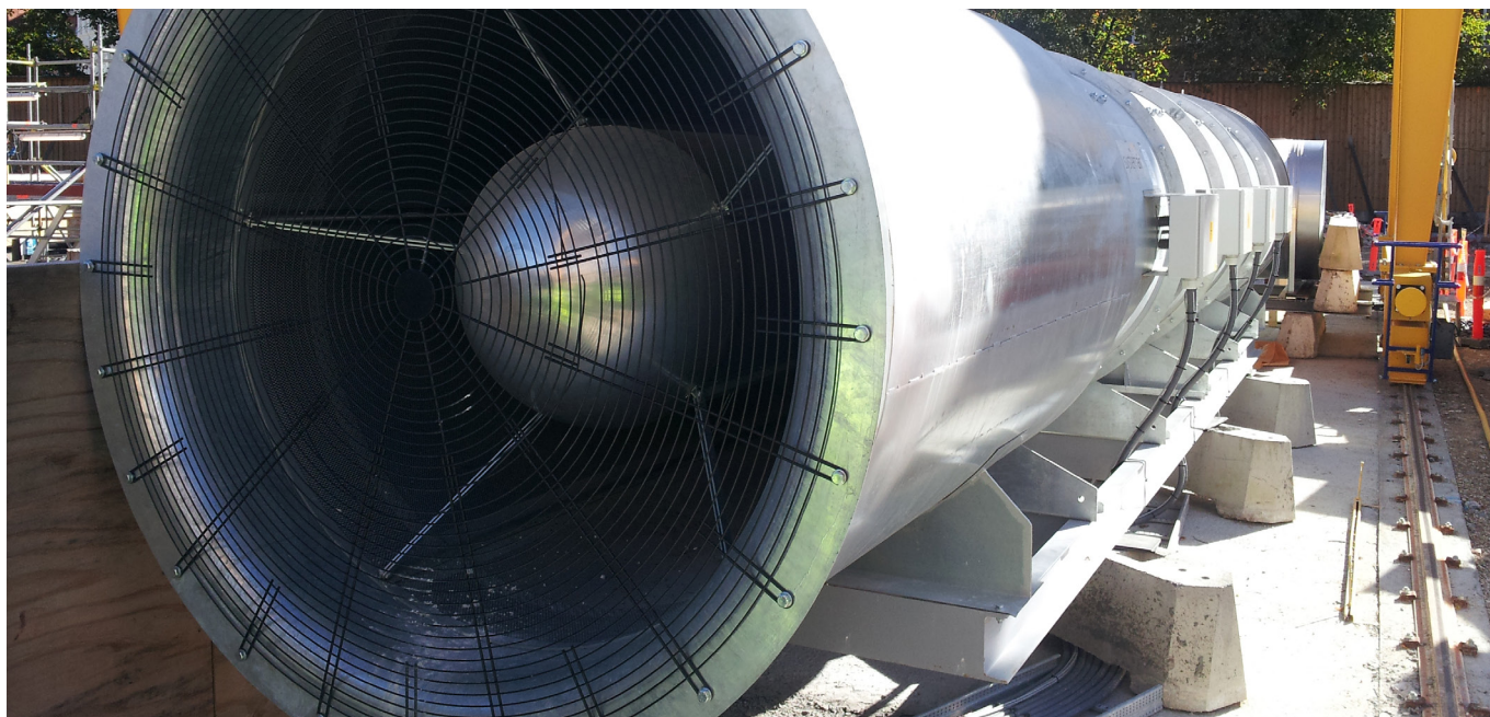
Ventilatore quadristadio Systemair 4 x 75 kW
